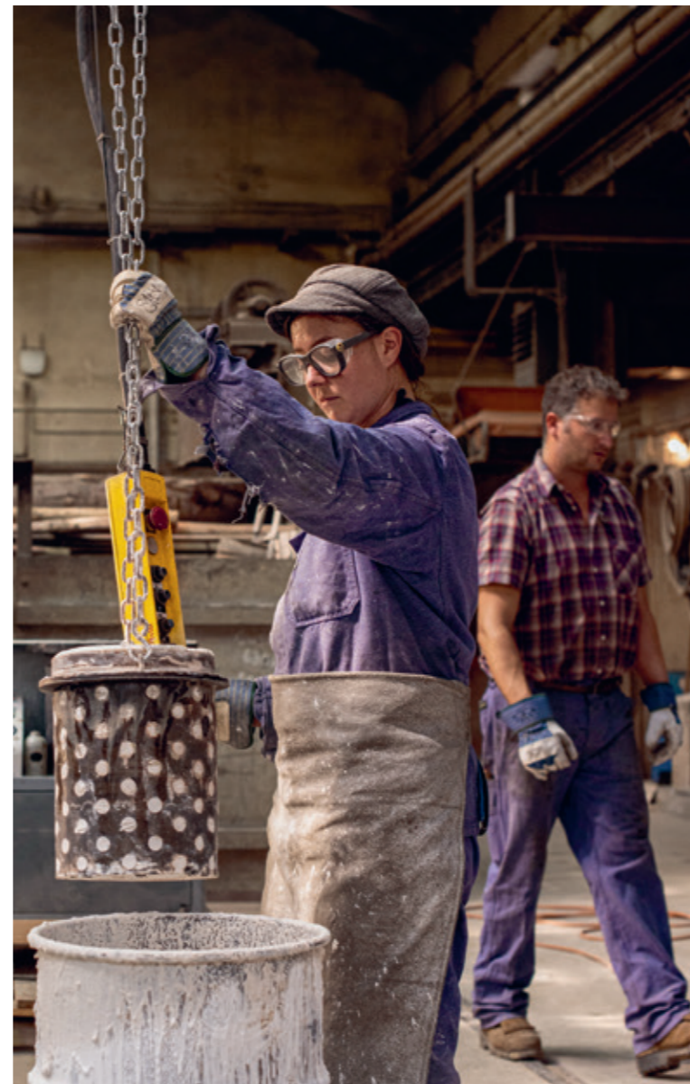
Silvie Gorath lässt die Kuvette zum Abkühlen ins Wasserbad. Inhalt: ein Basiliskenkopf, zirka 650°C heiss.
